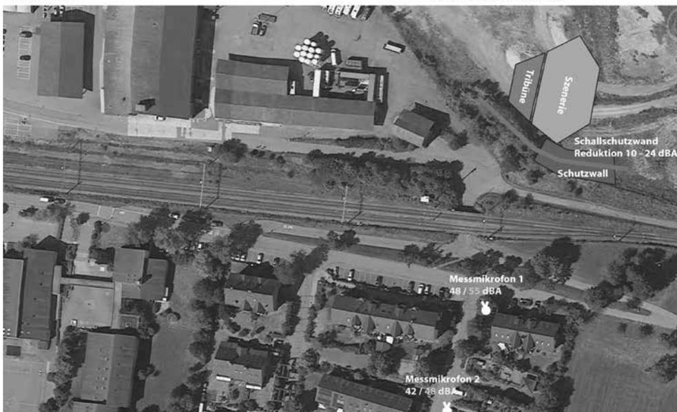
Schallschutzmassnahmen mit dem Schutzwall und der Schallschutzwand reduzieren den gemessenen Schall um mindestens 10 bis 24 dBA
